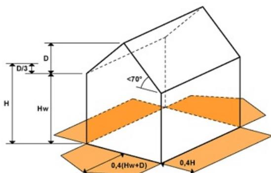
Abstandsflächen bei Dachneigungen  $\geq 70^\circ$ :
