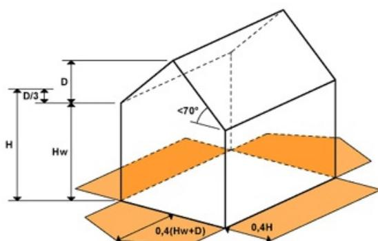
Abstandsflächen bei Dachneigungen  $\geq 70^\circ$ :
